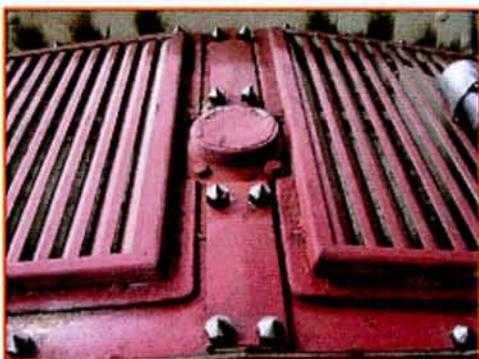
*Griglie vano motore sabbiate e primerizzate*
