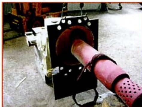
*L'arma sabbata, primerizzata e verniciata con l'antiruggine viene montata sulla staffa*
